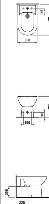
**Opciones:** .304 1 agujero para grifería, .308 3 orificios para grifería. Ambos sin orificios laterales para entrada de agua
