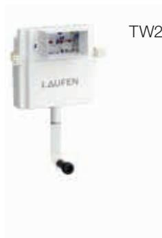
LIS permite la instalación de inodoros con cisternas de alto nivel en construcciones de media pared o pared de ladrillos, lo que únicamente requiere de una anchura de 125 mm. Una cisterna de descarga dual de ahorro de agua de 6/3 litros ajustable a 4,5/3 litros, así como la tubería de conexión al inodoro forman parte del envío.
