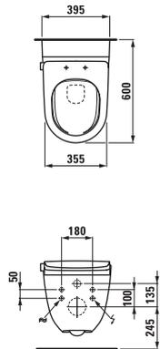
Conexiones con bastidor LAUFEN LIS CW2
