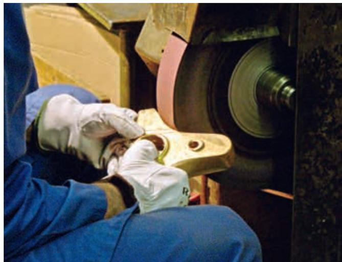
Fase de mecanizado de precisión y pulido
