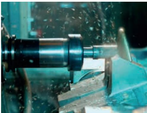
Fase de mecanizado (desbaste, taladrado, etc)
