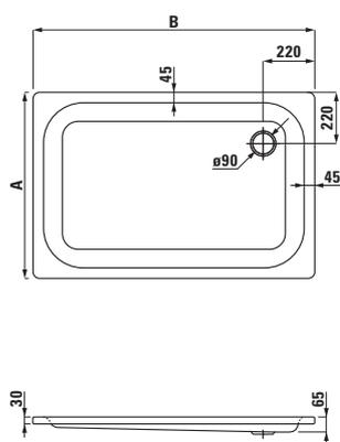
Plato de ducha cuadrado, acero esmaltado de 3,5 mm, plano de 65 mm, con revestimiento de aislamiento acústico
